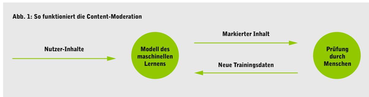
Abbildung 1 zeigt die Grundpfeiler der Content-Moderation. Von Nutzenden erstellte Inhalte gelangen in ein Soziales Netzwerk oder ein anderes digitales System, in dem eine Reihe von Algorithmen für maschinelles Lernen ausgeführt wird, um die Angemessenheit der Inhalte automatisch zu prüfen und zu bewerten.
